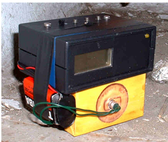
Ryc. 14. Samodziałowe urządzenie wybuchowe o działaniu zwłocznym opartym na zegarze kwarcowym
