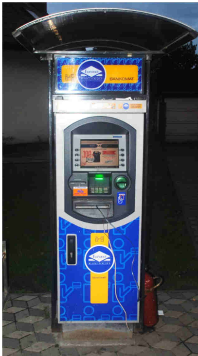
Ryc. 18. Bankomat przygotowany do otwarcia wybuchowego (butla acetylenowa z wężkiem i przewodami elektrycznymi wprowadzonymi do sejfów przez podajnik banknotów)
