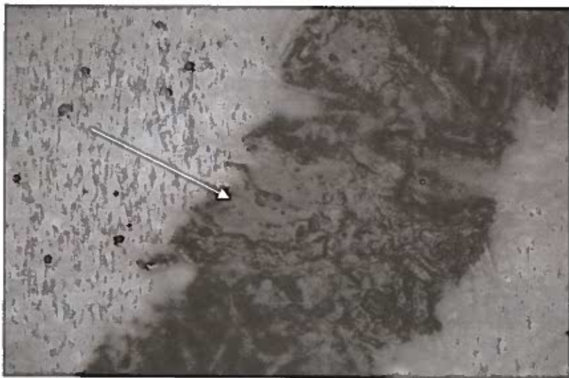
Ryc. 18. Zapis wykonany długopisem, który przeszedł przez drukarkę laserową (widoczne spieki) – powiększenie 200× (źródło: raport końcowy z realizacji projektu OR 00001911) 60
