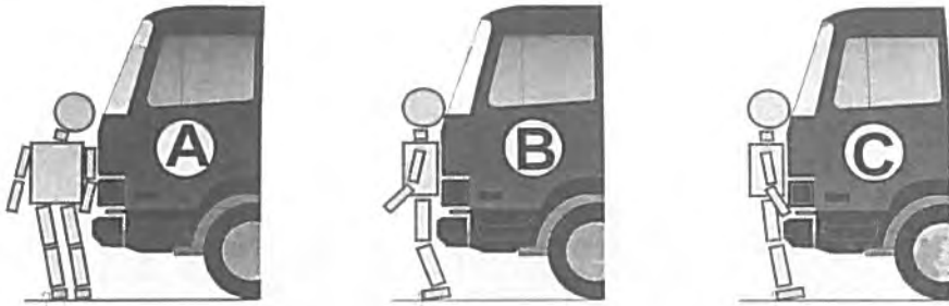
Ryc. 4. Mechanizm powstania zarysowań (zaznaczono je strzałkami) na podszwach obuwia w przypadku potrącenia przez samochód ciężarowy.
