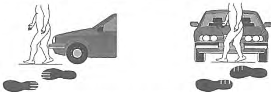
Ryc. 2. Usytuowanie zarysowań na podszwach obuwia z fazą ruchu pieszego potrąconych przez samochód osobowy od strony tylnej i bocznej.
