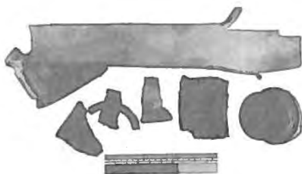
Fot. 8 Odłamki stalowej bomby rurowej. Wypełnienie: materiał o małej prędkości detonacji
