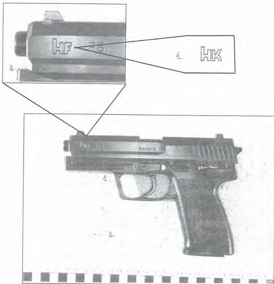
Ryc. 4. Pistolet pneumatyczny na amunicję plastikową kal. 6 mm produkcji tajlandzkiej, użyty do napadu na pocztę. 1 – pistolet stanowi model pistoletu Hekler und Koch, HK USP kal. 9 mm, produkcji niemieckiej, 2 – amunicja plastikowa kal. 6 mm do ww. pistoletu, 3 – stylizacja liter HF na oryginalne znakowanie broni przez Firmę Hekler und Koch, 4 – wygląd oryginalnego logo Firmy Hekler und Koch.
